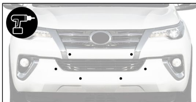
E) Depois de posicionar o overbumper (2 partes), fazer a furação conforme locais marcados com tinta na etapa anterior.
