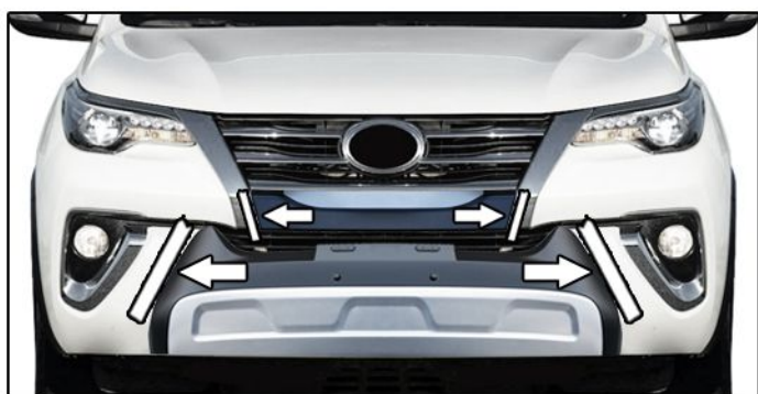
D) Posicionar o overbumper (2 partes) no para-choque do veículo alinhando-o conforme marcação da fita na etapa "B".
