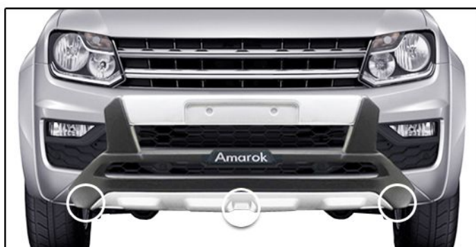
I) Finalizar a instalação fixando os 3 parafusos 6,3 x 19 conforme marcação da peça.
