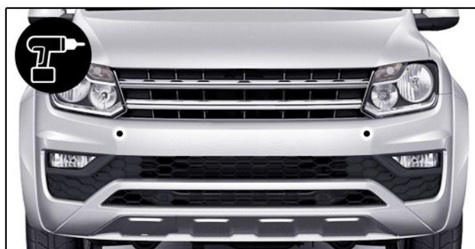
E) Depois de posicionar o overbumper, fazer a furação conforme locais marcados com tinta na etapa anterior.
