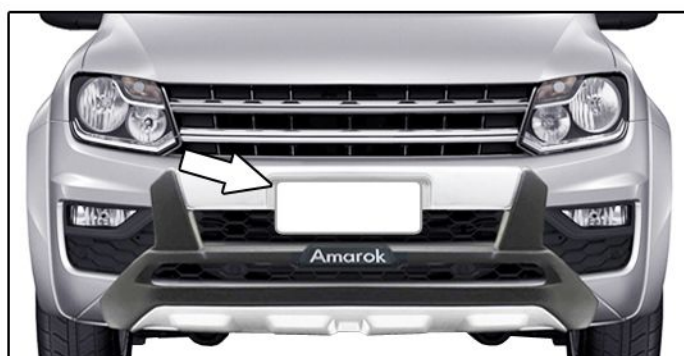
J) Fixar a placa do veículo conforme local indicado utilizando os parafusos retirados na etapa "A".
