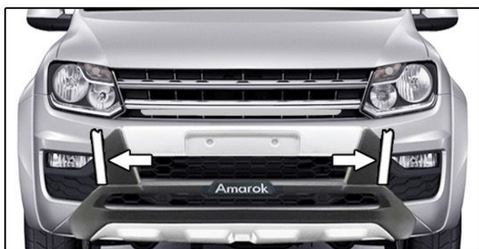
D) Posicionar o overbumper no para-choque do veículo alinhando-o conforme marcação da fita na etapa "B".
