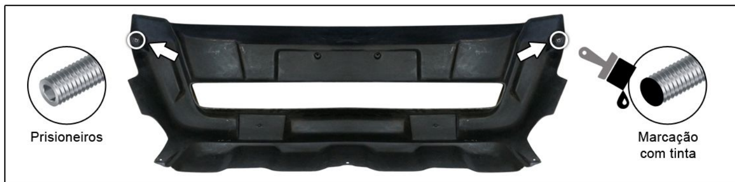
C) Inserir os 2 prisioneiros nos insertos da peça conforme locais indicados. Em seguida, faça uma marcação com tinta na ponta dos prisioneiros (essa marcação serve p/ verificar os locais de furação do para-choque conforme etapa seguinte).
