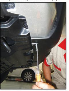
Etapa 3 Pocicionar a porca rápida no parachoque do veículo para fixação do overbumper.
