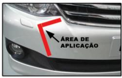
Etapa 4 Desgrudar uma ponta da fita adesiva p/ facilitar sua retirada.
